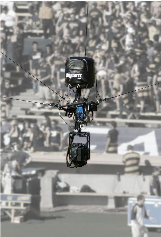
Eine Seilkamera die im englischen auch Spidercam genannt wird, ist ein kleiner Kamerawagen der an gespannten Seilen befestigt ist. Sie werden in einem Gebiet von mehreren Ecken angespannen wie beispielsweise in der Film und Fernsehproduktion zur Verfolgung von schnell bewegten Ereignissen. Bei der Übertragung eines Fußballspiels, wird die Spidercam oft verwendet um spektakuläre Verfolgungen von Oben aufnehmen zu können.
